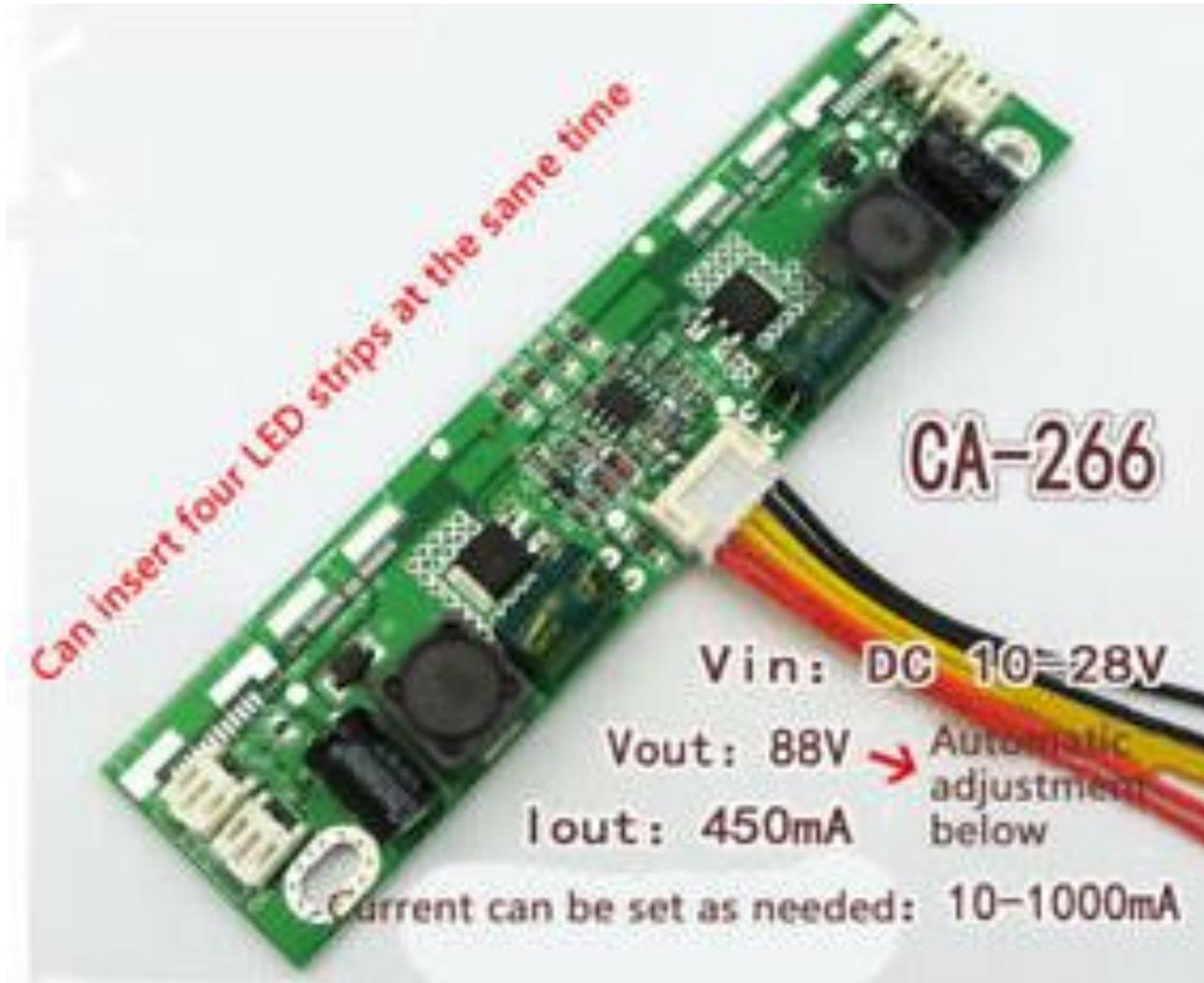
Pada bagian driver atau *inverter backlight* ini berfungsi untuk menyediakan arus dan tegangan listrik yang dibutuhkan oleh lampu backlight atau cahaya belakang TV LED.
