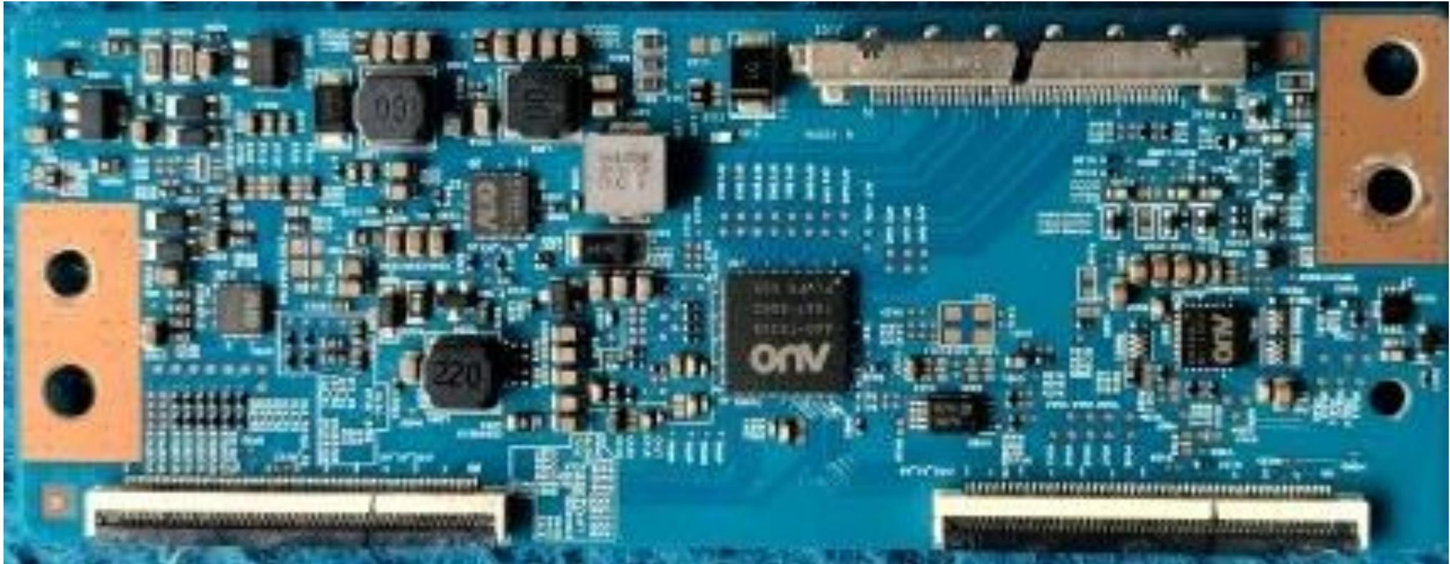
Timing Control atau lebih dikenal dengan singkatan T-CON merupakan jembatan yang mengatur pewaktuan kapan sebuah pixel pixel pada layar LCD harus menyala dan kapan harus padam
