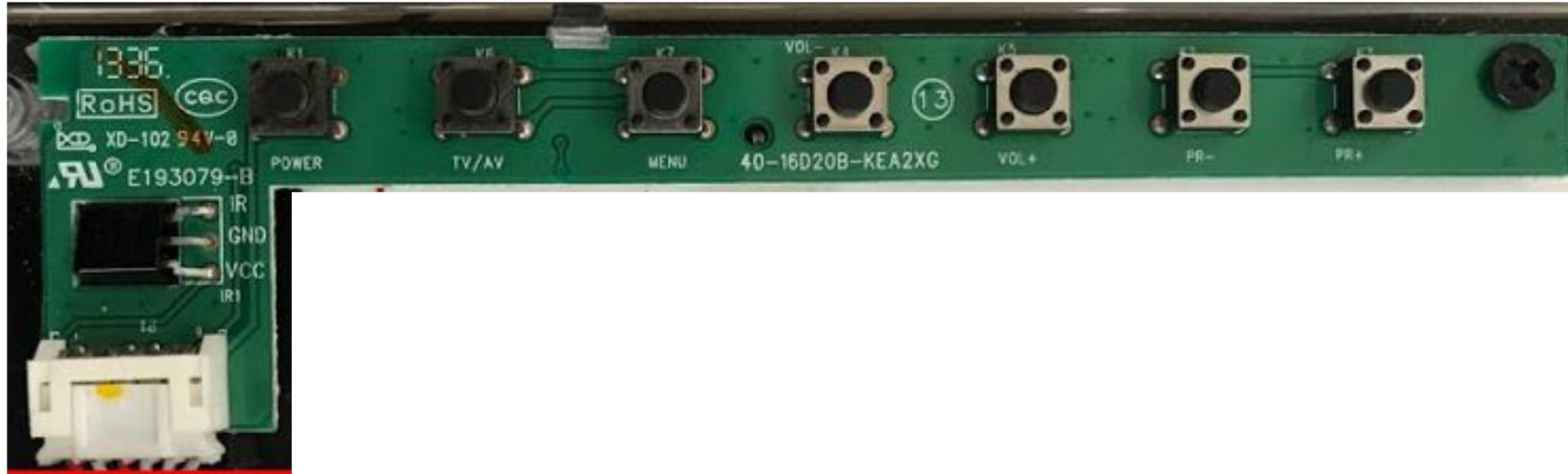
Bagian blok panel kontrol atau tombol kontrol digunakan untuk mengontrol pesawat TV LED secara manual atau menyentuh langsung fisik TV nya. Tombol kontrol biasanya untuk mengatur Menu, Chanel Plus dan Minus, Volume plus dan minus. Namun terkadang juga ada panel kontrol yang memiliki banyak tombol atau bahkan hanya satu tombol saja.
