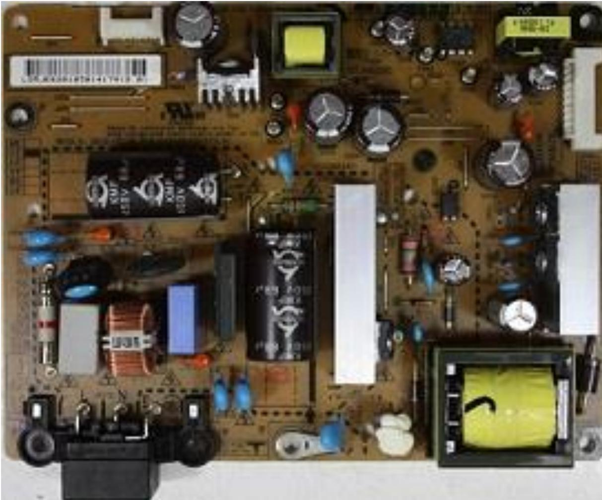
Bagian blok power supply switching berfungsi untuk menyediakan arus dan tegangan listrik yang dibutuhkan oleh seluruh bagian pada pesawat TV LED. Biasanya tegangan listrik DC yang dihasilkan oleh bagian power supply switching mulai dari 3,5 volt sampai dengan 200 volt. Tegangan rendah 3,5 volt umumnya digunakan untuk catu daya power standby bagian blok Mainboard. Namun ada juga yang menggunakan tegangan 5 volt.
