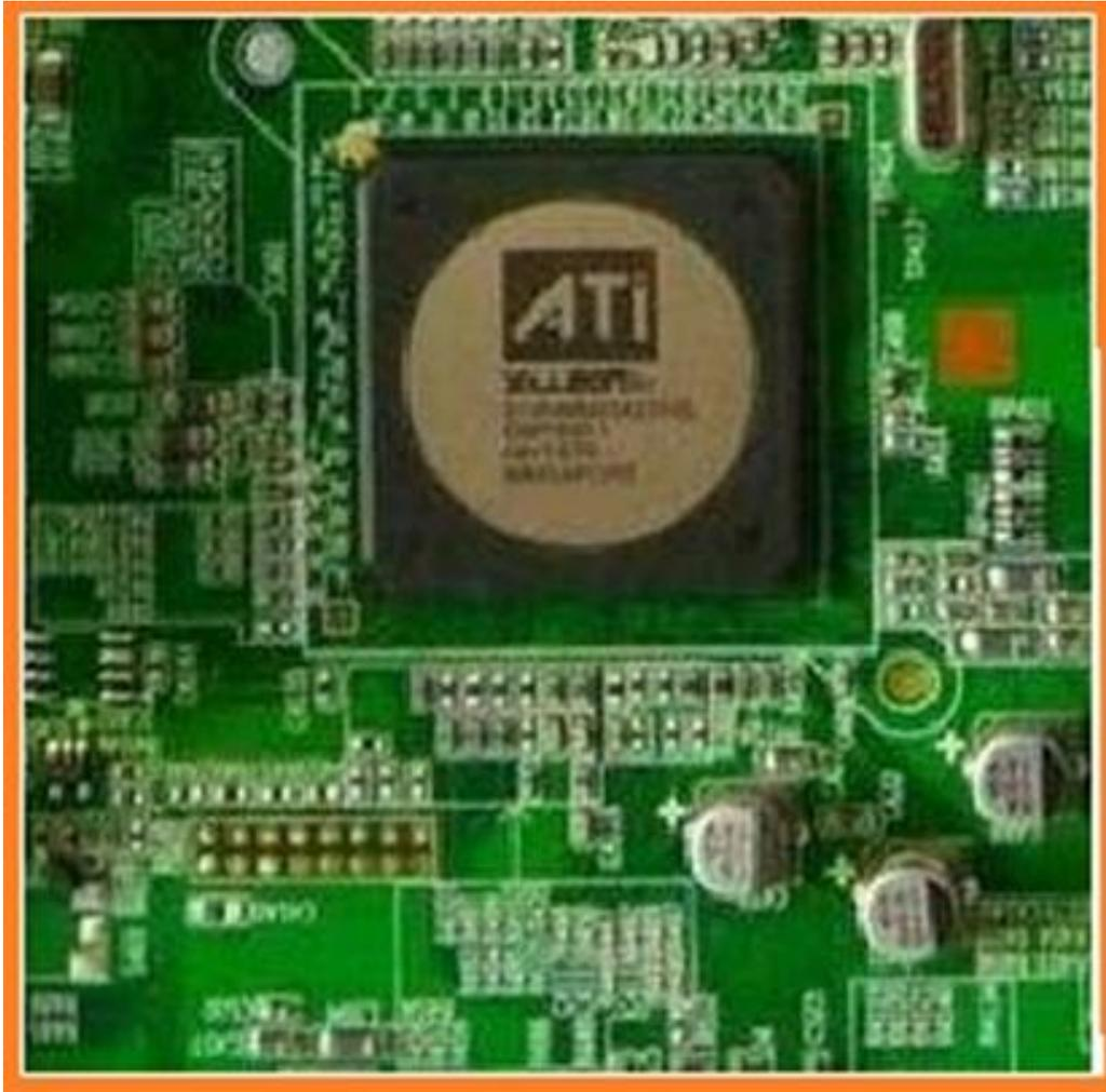
Unit pemrosesan video atau video prosesing unit adalah rangkaian terintegrasi yang mencakup CPU (Central Prosesing Unit), HD (High Def.) / SD (Standard Def). Video dan audio decoder, decoder video NTSC, OSD (On Screen Display) yang menyaring video scaler dan deinterlacer.
