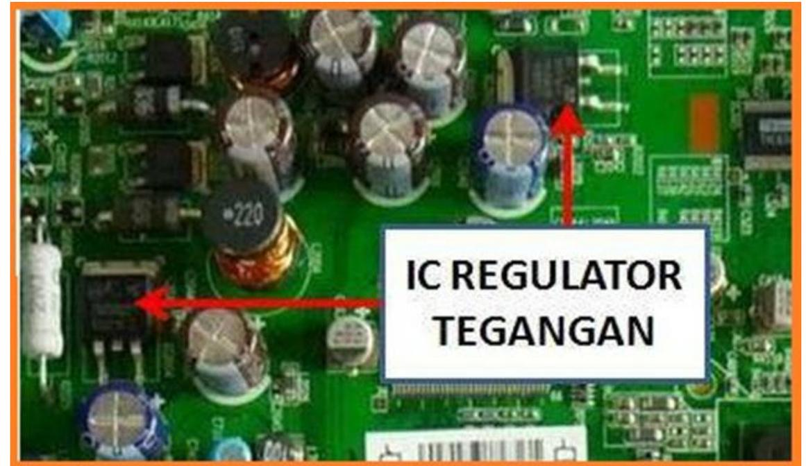
IC Regulator tegangan memberikan tegangan yang stabil konstan untuk IC dan rangkaian lain yang terdapat di mainboard.
