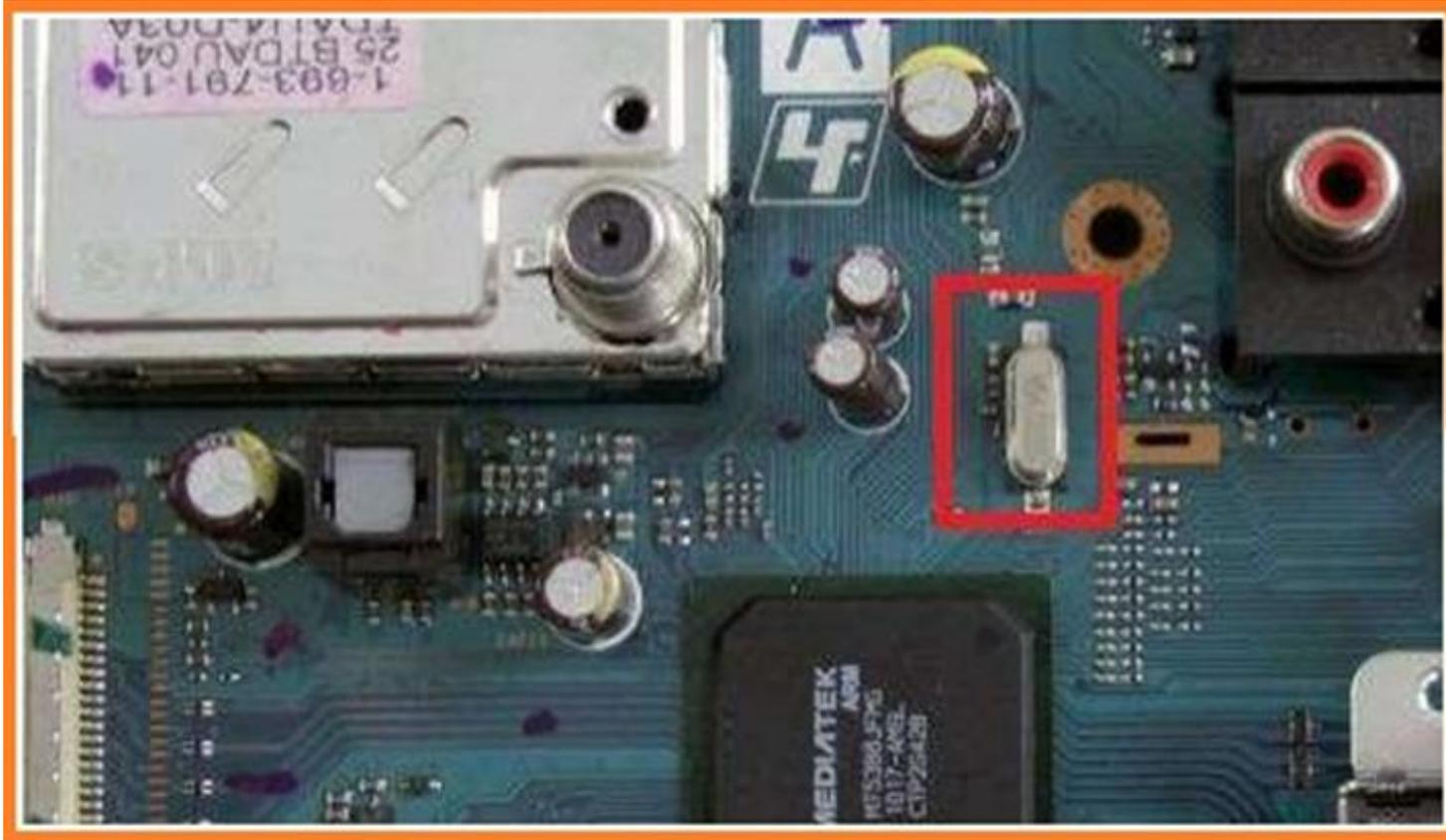
Fungsi kristal dalam kombinasi dengan komponen lain untuk menghasilkan sinyal listrik dengan frekuensi yang sangat tepat. Frekuensi ini dipakai untuk memberikan sinyal clock yang stabil ke IC. Jenis yang paling umum di TV LCD adalah osilator kristal kuarsa
