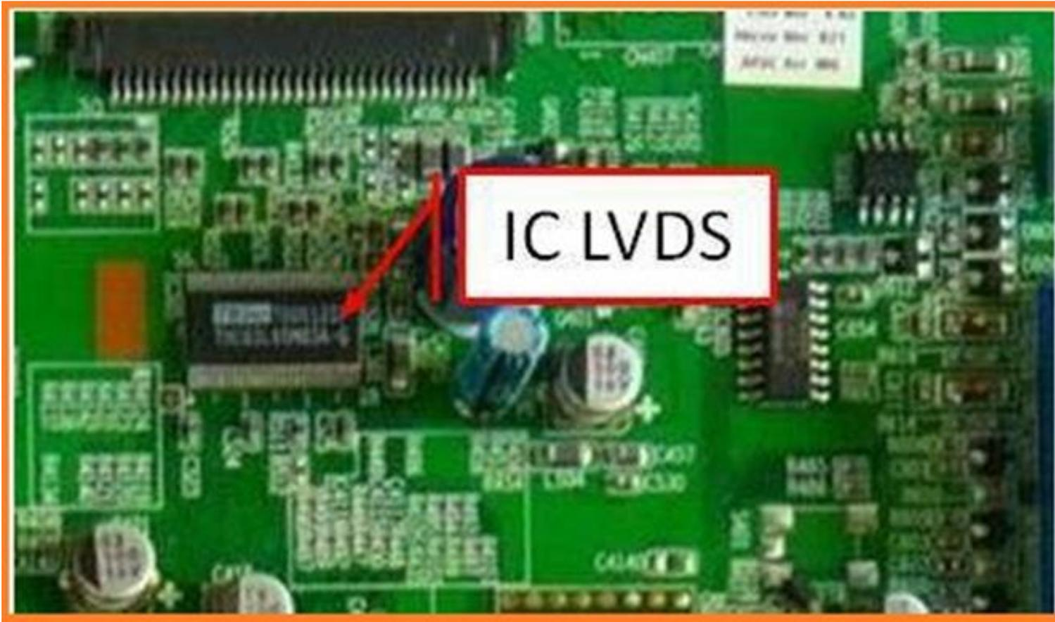
IC LVDS memakai *diferensial* sinyal tegangan rendah untuk mengirim sinyal video dari *mainboard* ke papan pengontrol T-Con/LCD. LVDS adalah sistem sinyal *diferensial*, LVDS mengirimkan dua tegangan yang berbeda yang dibandingkan pada penerima akhir. LVDS memakai perbedaan tegangan untuk mengkodekan sinyal video.
