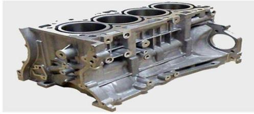
Gambar 3.8 Silinder terdapat pada blok mesin
